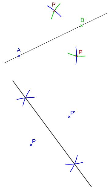
Wenn zwei Punkte P und  $P'$  gegeben sind und man die Symmetrieachse (=Mittelsenkrechte) konstruieren möchte, muss man je einen Kreis um die beiden Punkte mit gleichem Radius ziehen. Es entstehen zwei Schnittpunkte, welche man zu einer Geraden verbindet.
